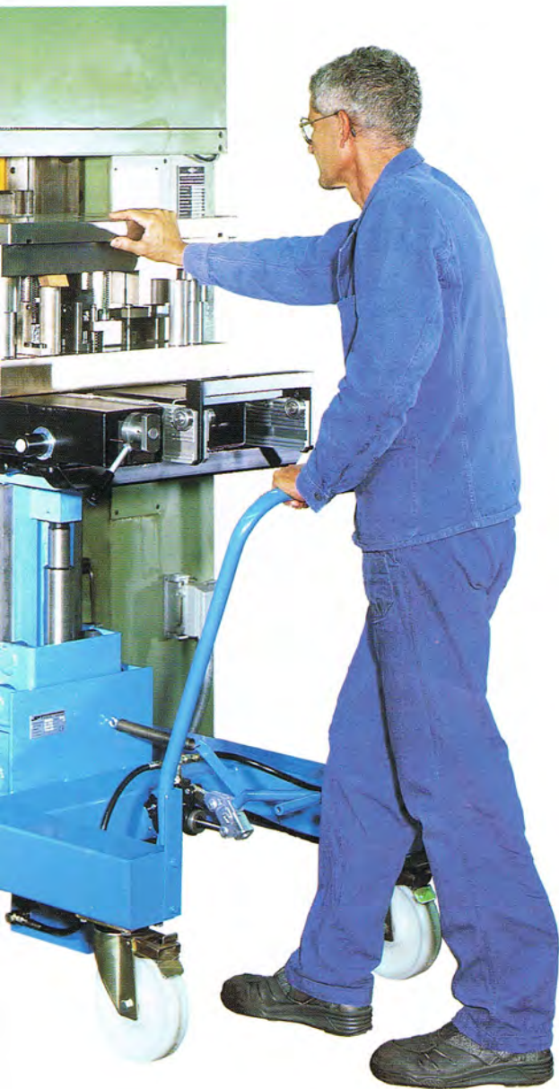
Le chariot de changement d'outillage EDL-4. Charge admissible: 2500 kg avec plateforme 4SA / 4R / 4U / 4L (4RV - 4000 kg)
